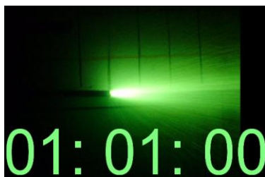
Фиг.3.6 Горене на електрод за подводно електро-кислородно рязане във въздушна среда. Начало и край на отчитане.
