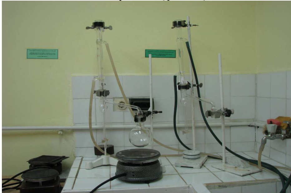
Фиг. 27. Изображение на стенда използван за определяне на съдържащото се количество вода във ВГЕ.
