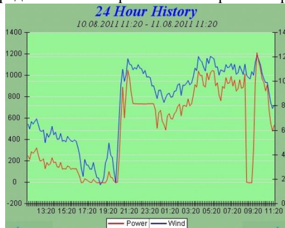
Фиг.2.9. Дневно разпределение на скоростта на вятъра и генерирана мощност 11:20 10.08. ÷ 11:20 11.08. 2011 г. 65 м.
